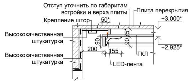
**Принципиальные детали отделки стен и потолка спальни**
